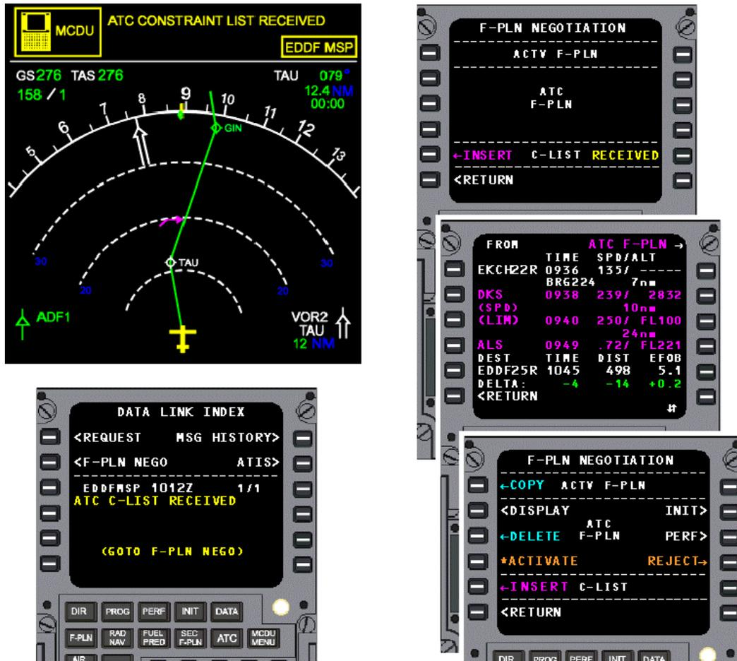
Abbildung 5: Ablauf einer bodeninitiierten Flugplanverhandlung (Endfassung)
