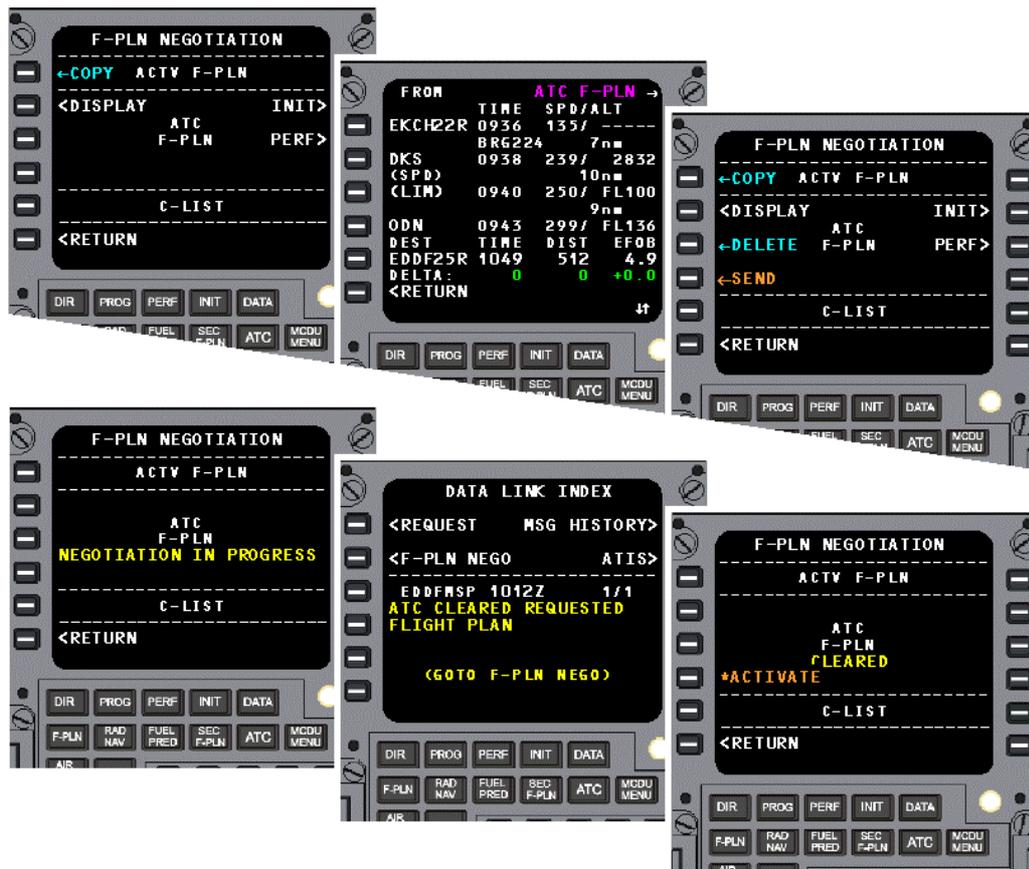
Abbildung 6: Ablauf einer bordinitiierten Flugplanverhandlung (Endfassung)
