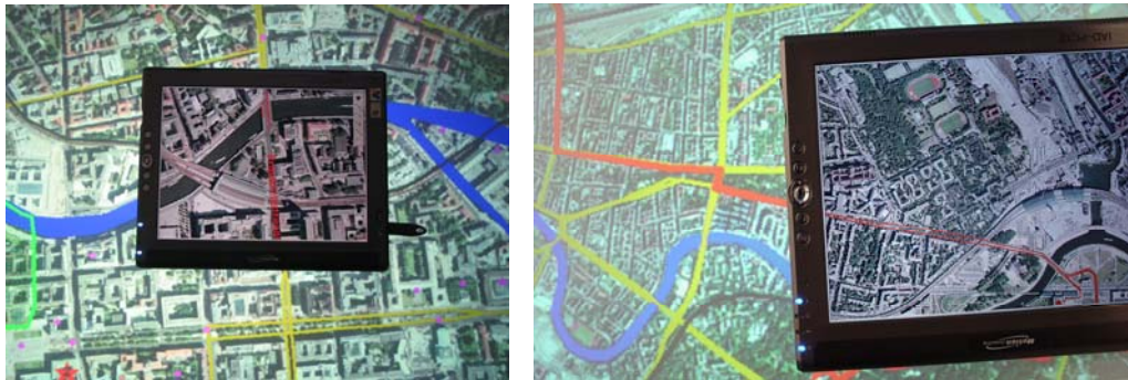
Abbildung 3: Das Fovea-Tablett zeigt jeden beliebigen Szenenausschnitt des Tischdisplays in hoher Auflösung an und liefert damit die Funktionalität einer verdeckungsfreien Lupe.
