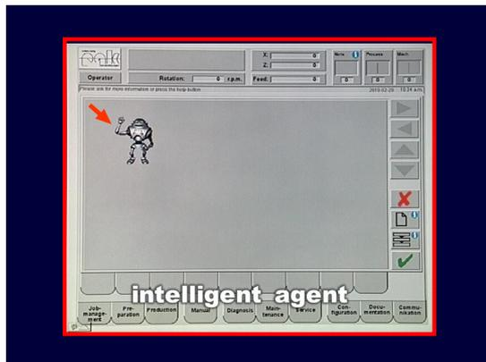
Nach Begrüßung von Mike durch einen intelligenten Assistenten (speech control, intelligent agent), muss zunächst die Blick- und Gestenerkennung der Maschine kalibriert werden (gaze recognition bzw. eye tracking, gesture recognition).
