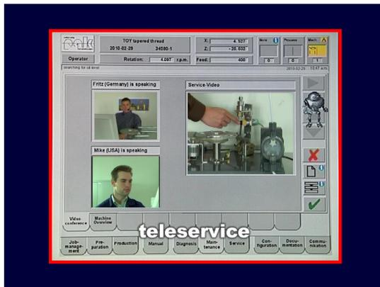
Nachdem die Verbindung hergestellt ist, möchte der zuständige Service-Ingenieur Fritz das Problem zunächst mit eigenen Augen sehen und bittet Mike, mit der Handkamera die beschädigte Ölpumpe zu filmen (local area network).
