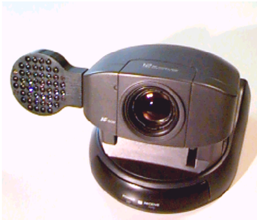
Abbildung 4-2: Gazetracking-Kamera: Mit einem Infrarotlicht wird das Auge beschienen. Die bewegliche Kamera richtet sich auf das Auge aus und nimmt es auf.
