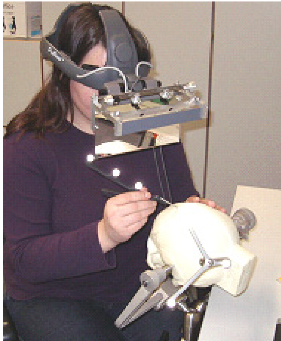
Abb.1 Durchführung der Versuchsaufgabe mit dem Spiegel-HMD
